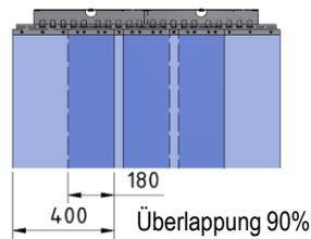
**Sicherheitshinweis: Die PVC-Streifen müssen immer so weit gekürzt werden, dass sie nicht auf dem Boden aufstehen, um ein Ausreißen durch Überfahren mit Staplern o.ä. zu verhindern.**
