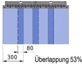
Die PVC-Streifen werden in der Länge 20 mm über OK Fußboden gefertigt. Nach einigen Tagen in geheizten Räumen hängen sich die Streifen aus. Nach längerer Zeit können sich die PVC-Streifen so weit gelängt haben, dass diese auf dem Fußboden aufstehen. Die Streifen können dann einfach mit dem mit-gelieferten Messer gekürzt werden.
